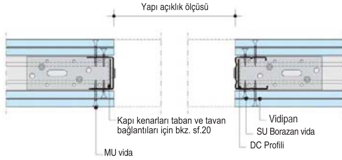
W112- E2 DC Duvar Profili Kapı Boşluğu
