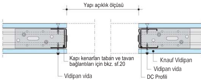
W111- E2 DC Duvar Profili Kapı Boşluğu
