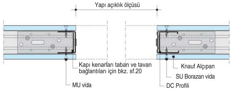
W111- E2 DC Duvar Profili Kapı Boşluğu
